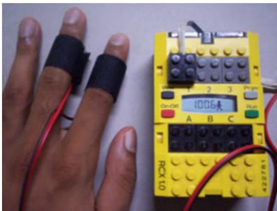
Fig. 4. LEGO GSR sensor unit.
